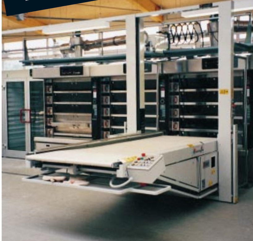
1996 Boulangerie Escherich, à BÜCHLBERG en Allemagne 3 CERVAP 10.16 et 3 fours rotatifs 8.60 avec enfournement/défournement automatique.
