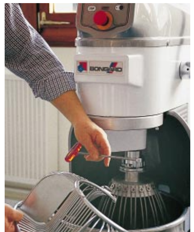
Démontage facile de la grille de protection.
