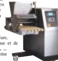
Avec ses nombreux accessoires, la Delta permet la confection de produits à base de pâte molle (choux, meringues, génoises, ...) et à base de pâte dure. L'option remplissage permet l'injection de crème lisse et de confiture dans des produits tels les éclairs, les cakes, ... Sa rapidité et sa régularité de dépose en font une machine particulièrement destinée à un milieu industriel.
