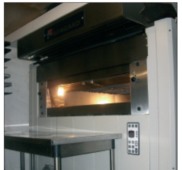
L'étage électrique traversant du CERVAP GME possède son propre tableau de commande
