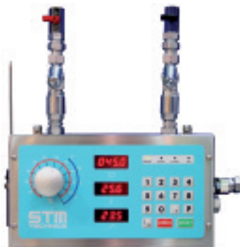
Doseur-mélangeur Domix 45 : la température de l'eau est mesurée et visualisée directement sur l'écran de contrôle. Une sélection de programme permet de déterminer automatiquement les température et quantité d'eau nécessaires à la recette
